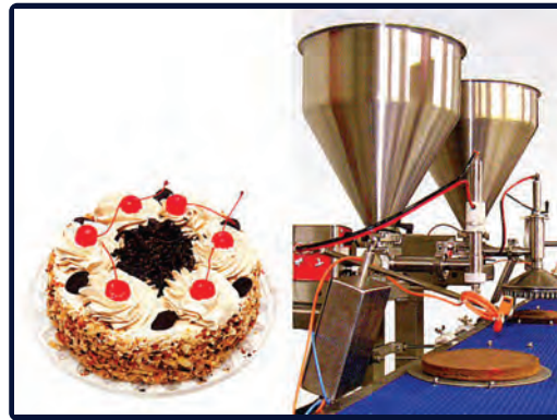
Linha automática de dosadores
